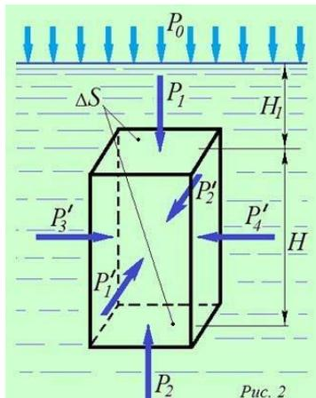
Итак, гидростатическое давление в любой точке внутри покоящейся жидкости равно сумме давления на свободную поверхность со стороны внешней среды и давления столба жидкости высотой, равной глубине погружения точки (т. е. ее расстоянию от свободной поверхности жидкости). Закон Паскаля: внешнее давление, производимое на свободную поверхность покоящейся жидкости, передается одинаково всем ее точкам по всем направлениям.
