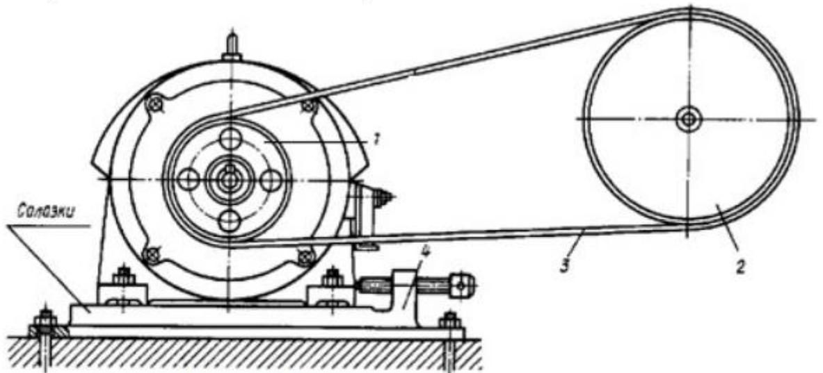
Рис.1.1. Схема ременной передачи:
